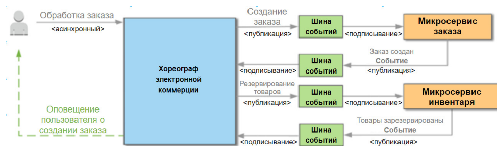
Рис. 5. Пример системы электронной коммерции с использованием микросервисной архитектуры и паттерна «Сага»
